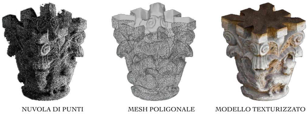
Fig. 70 - Fasi per la generazione del modello texturizzato finale.
